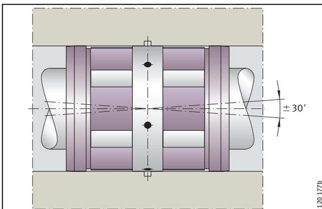
Bild 1 · Ausgleich von Fluchtungsfehlern
